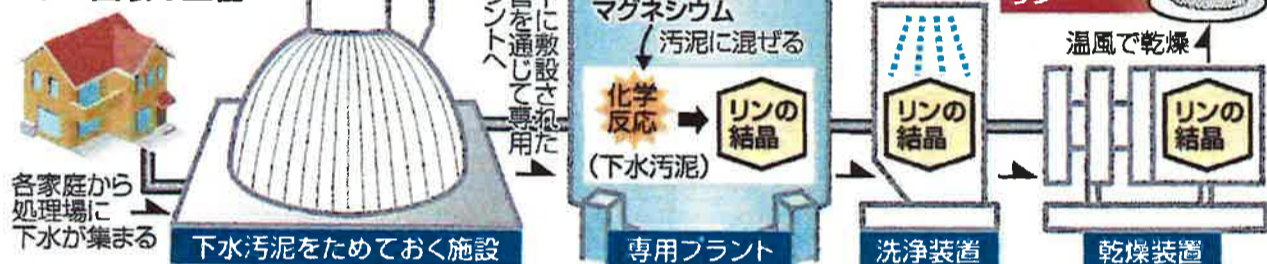
〓 神戸市でのリン回収の工程
